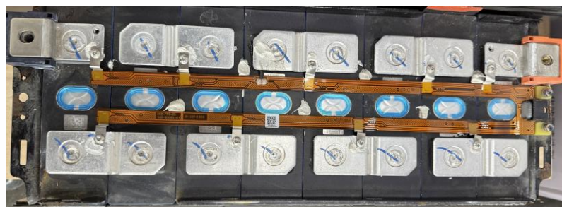
Figura 3 - Distribuição de células 1P8S LFP25,76V 302Ah
